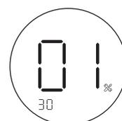
Рис. 23. Настройка времени задержки пуск котла в Эко-режиме.
