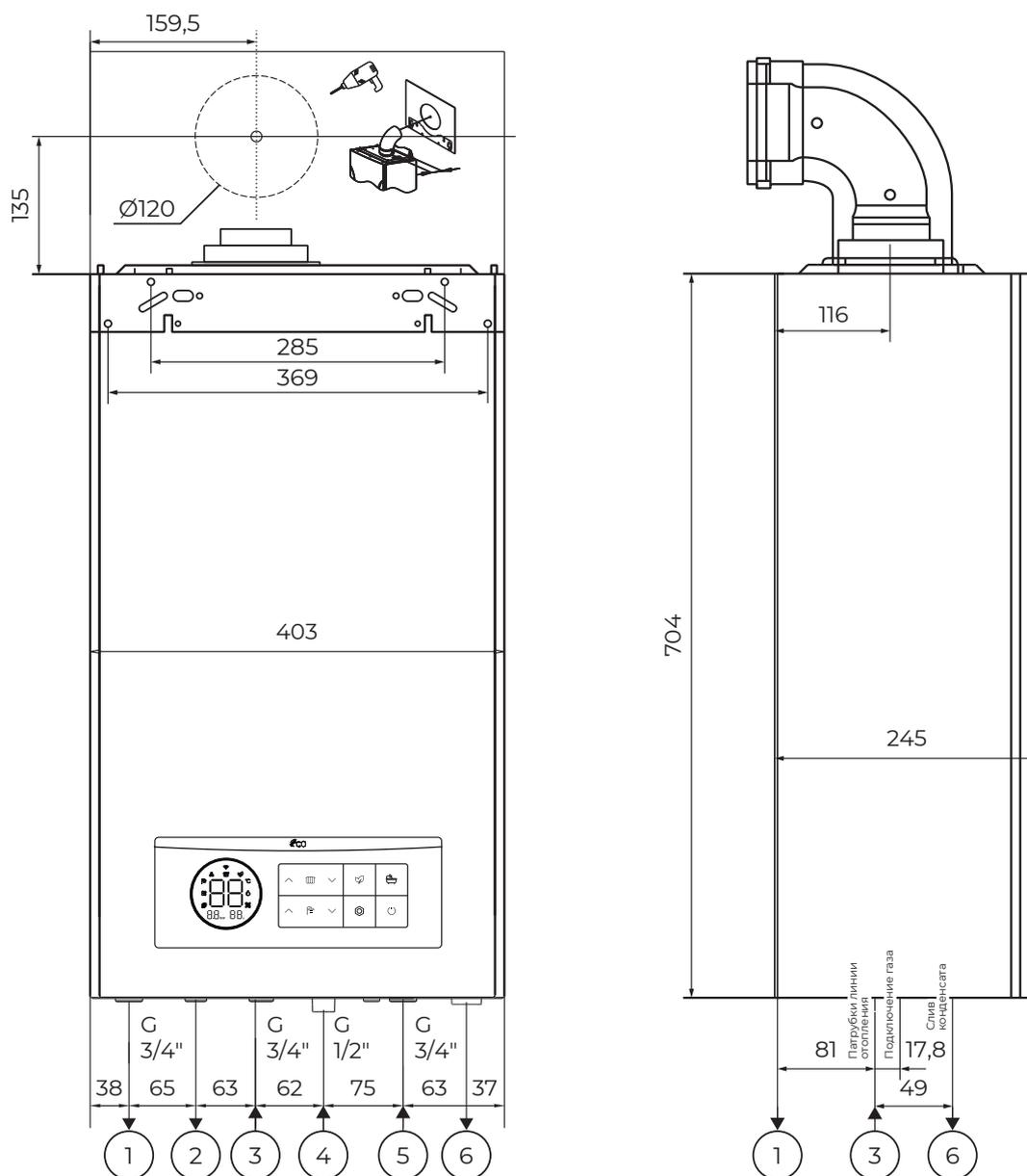
Рис. 30. Монтажные размеры M30 26 C/H, M30 30 C/H
