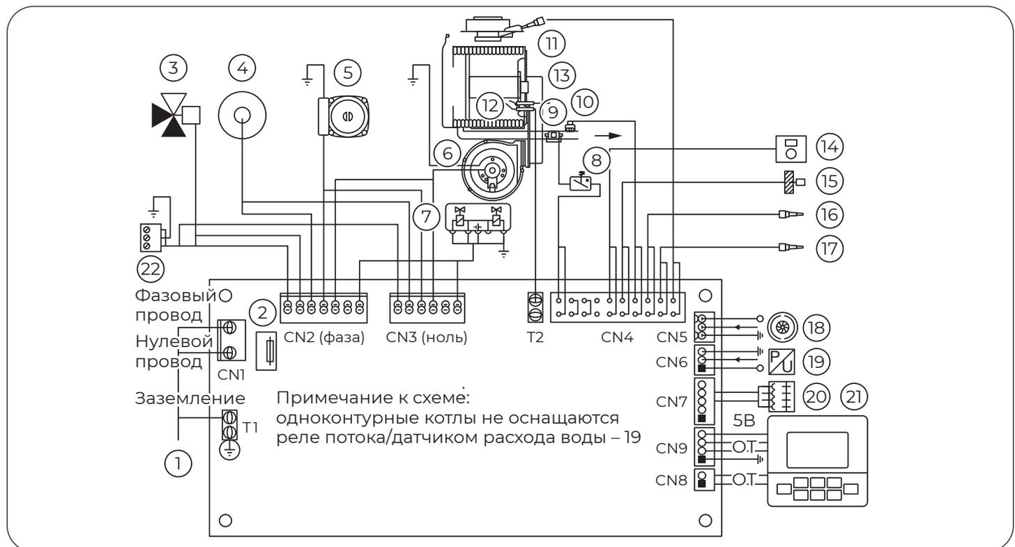
Рис. 35. Электрическая схема.
