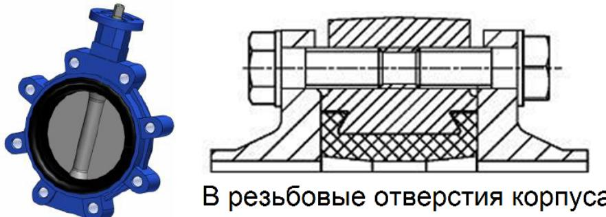
На рисунке показано крепление затвора болтами в резьбовые проушины.
