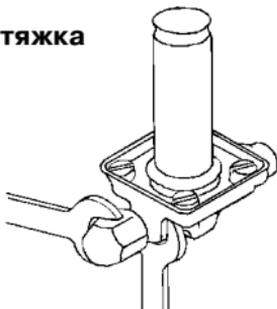
При затяжке трубных соединений следует применить контрусилые, т. е. необходимо использовать два гаечных ключа — на клапане и на трубном соединении, как показано на рисунке.
