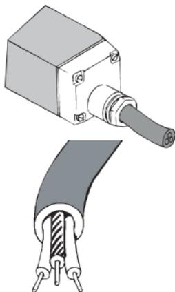
Для предотвращения попадания влаги в клеммную коробку через кабельный ввод кабель должен быть закреплен по всему диаметру. Следует учесть, что надежное уплотнение обеспечивается только для кабелей круглого сечения.
