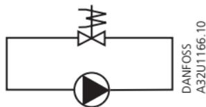
Для открытой системы, например для системы подачи питьевой воды, следует выбирать клапан с символом, указанным на рисунке справа.
