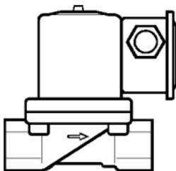
Для правильной работы клапан должен быть установлен так, чтобы направление стрелки совпадало с направлением потока.
