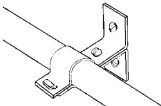
Трубы с обоих концов клапана следует надежно закрепить.
