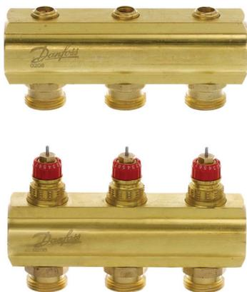
Распределитель состоит из подающего и обратного коллекторов. Подающий коллектор имеет возможность отключения каждого из контуров системы и может быть укомплектован ротаметрами (серия FHF-F). Обратный коллектор оборудован встроенными клапанами с предварительной настройкой пропускной способности, что позволяет обеспечить оптимальную гидравлическую балансировку системы.
