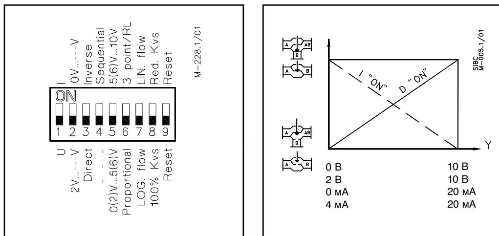
Под съемной крышкой привод содержит DIP микропереключатели выбора функции. Переключатели обеспечивают выполнение следующих функций:
