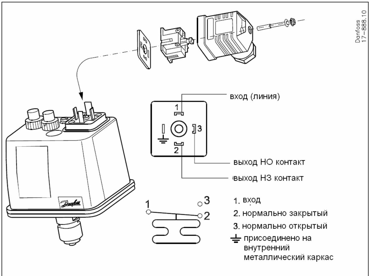
Для предотвращения явлений короткого замыкания электрическая нагрузка на контактную систему реле и любых других внешних контакторов или промежуточных реле должна выбираться с коэффициентом безопасности 0,6.
