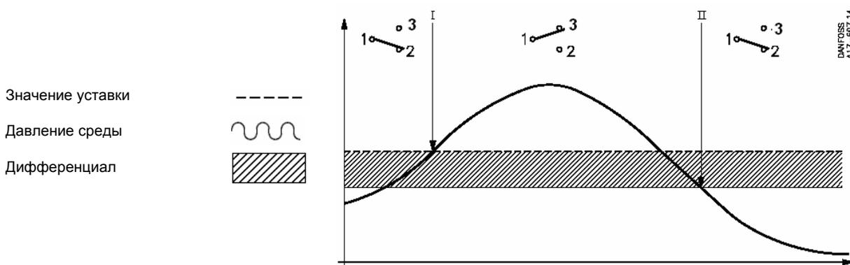
Рис. 1. Принцип действия – регулирования Max. reset.
