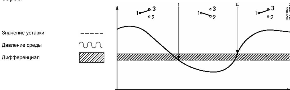
Рис. 2. Принцип действия – регулирования Min. reset.
