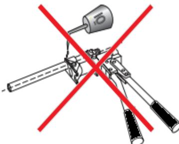
Трубу следует защищать от попадания на нее масел и не применять смазки при выполнении соединения с использованием подвижной гильзы
