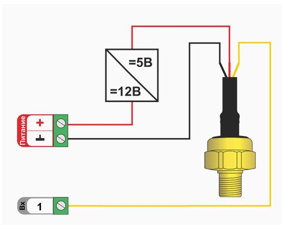
схема подключения к контроллерам ZONT
