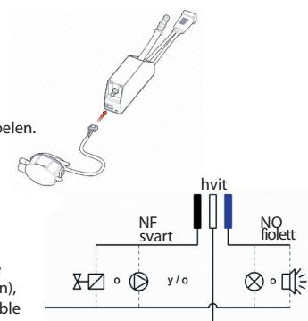
4 For tilslutning av alarmen, har du kontakten NF/NO (NF = normalt lukket, NO = normalt åpen), strømkuttstyrke anbefalt = 2A (5A Maks). Tilkoble alarmen i henhold til skjemaet for elektriske installasjoner.
