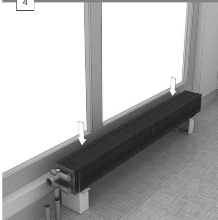
► Установите теплообменник конвектора на напольные консоли так, чтобы оси подающего и обратного трубопроводов были соосны с фиттингами подключения теплоносителя к конвектору.
