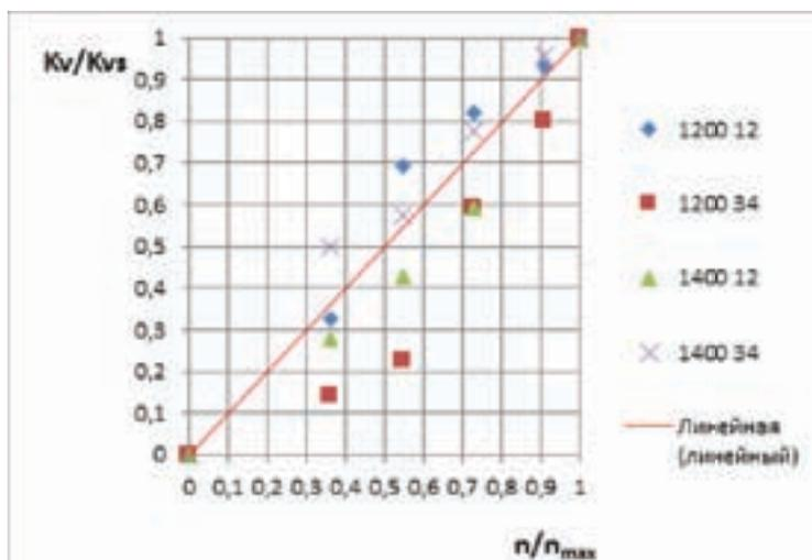
Рис. 25 - Расходная характеристика клапана
