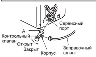
Если при креплении контрольного клапана к сервисному порту прилагать чрезмерное давление, сердечник клапана может деформироваться или открыться. Это может привести к утечке газа.
