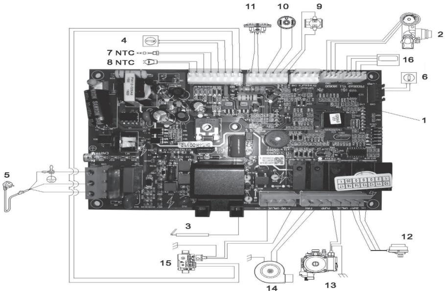
1- схематическое изображение соединений газового котла; 2- датчик потока; 3- электрод розжига ионизации пламени; 4- комнатный термостат и аксессуары (при отсутствии термостата делают замыкание накоротко); 5- кабель питания; 6- наружный датчик температуры; 7- датчик ГВС NTC; 8- датчик отопления NTC; 9- термостат; 10- датчик давления воды; 11- прессостат; 12- электронный трехходовой клапан; 13- циркуляционный водяной насос; 14- вентилятор; 15- газовый пропорциональный клапан; 16- дисплей;
