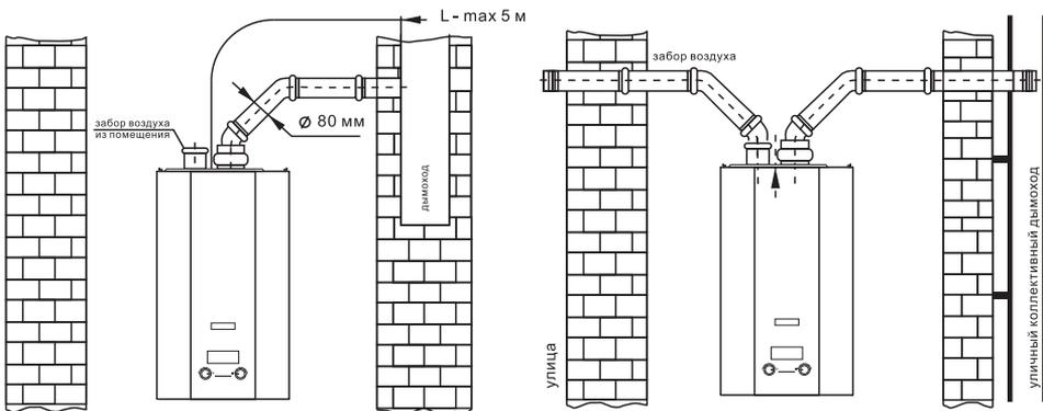
Котлы с закрытой камерой сгорания должны быть соединены с коаксиальными или раздельными дымоотводами и воздуховодами, которые должны быть выведены наружу через крышу или наружную стену (рис. А).
