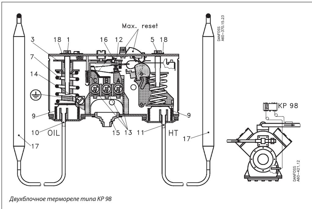
Двухблочное термореле типа КР 98
