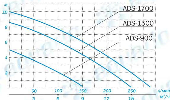
Заявленные гидравлические характеристики насосов справедливы при условии подключения к насосу трубопровода внутренним диаметром не менее 40мм незначительной протяженности и при напряжении в сети питания 220В.
