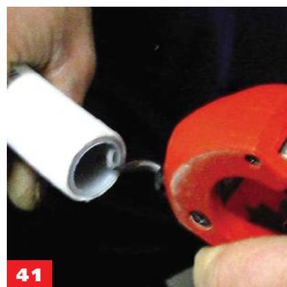
Изогнутый нож штыревой фаскоснимателя прислоняется к кромке трубы и им производятся круговые движения
