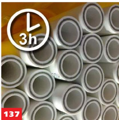
137 При транспортировке труб при отрицательной температуре перед распаковкой их следует выдерживать в помещении с положительной температурой не менее 2 часов.
