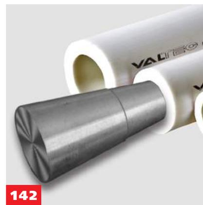
142 поэтому перед работой рекомендуется проверить трубу на наличие трещин с помощью конусного калибра. Вдавливание калибра в торец трубы поможет выявить трещины.
