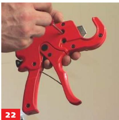
22 - отверткой с крестообразным на-конечником отвинчиваются оба винта крепления ножа;
