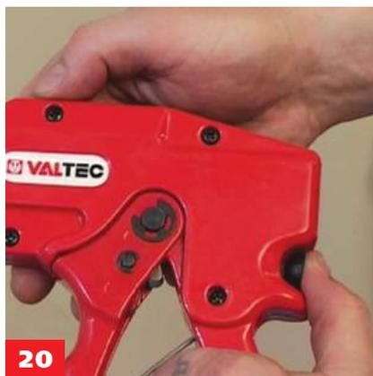
20 - после разрезания трубы нож приводится в исходное положение, для чего нажимается кнопка возврата
