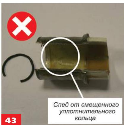
Отсутствие фаски может привести к повреждению уплотнительных колец штуцера, в результате чего при обжиме и опрессовке кольцо теряет проектное положение, что может послужить причиной протечки
