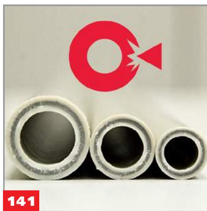
141 Если труба транспортировалась при отрицательной температуре, а затем была неосторожно выгружена, на её торцах могли появиться микротрещины,
