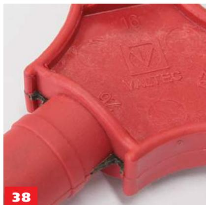
Если используются калибраторы VALTEC, то снятие фаски можно производить одновременно с калиброванием, для чего в основании калибровочных штырей имеются фасочные ножи
