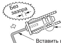
Не наносите смазочное масло (фреоновое масло) на сливную пробку при установке. Масло повреждает сливную пробку и приводит к утечке воды.
