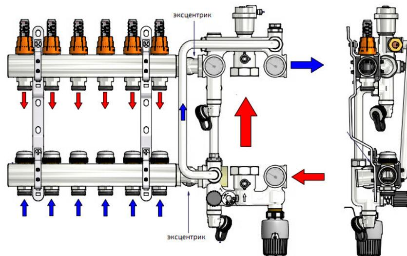
В этом случае для присоединения к коллекторам тёплого пола потребуется дополнительная пара эксцентриков *VTr.094 G1"*.
