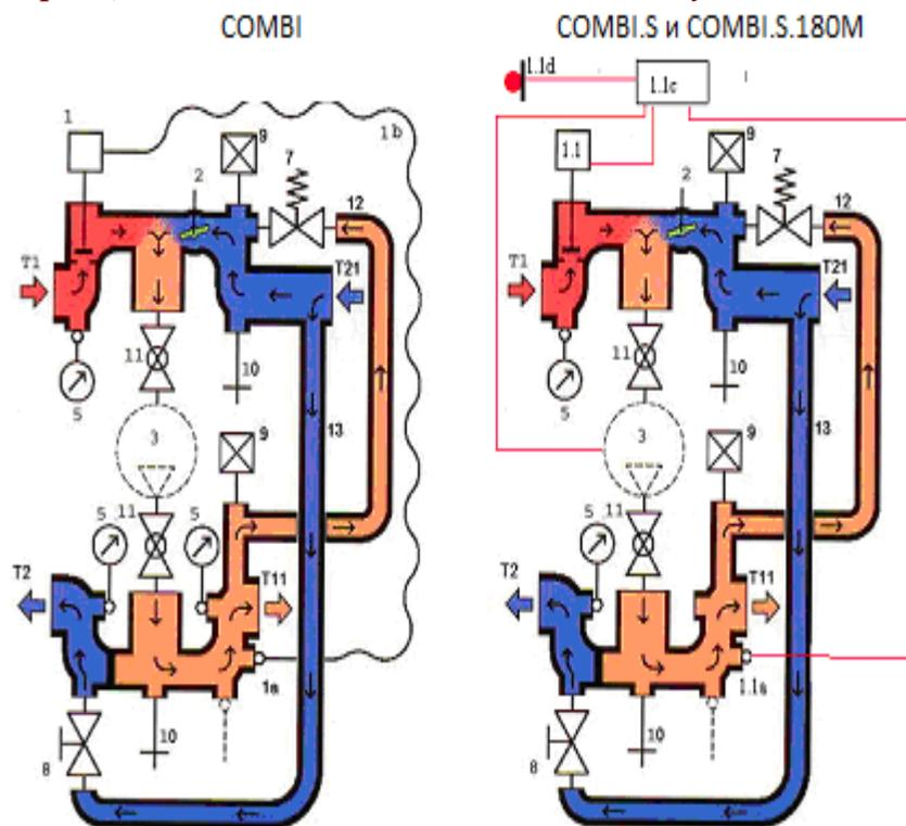
Теплоноситель первичного контура  $T1$  поступает в насосно-смесительный узел через термостатический клапан  $1$  ( $1.1$ ). В
