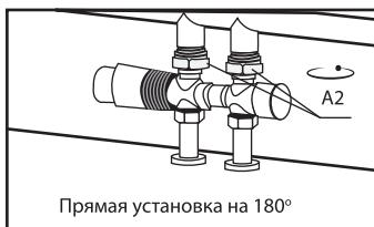
Затяните соединительный колпачок A2 с помощью инструмента T1 или T3
